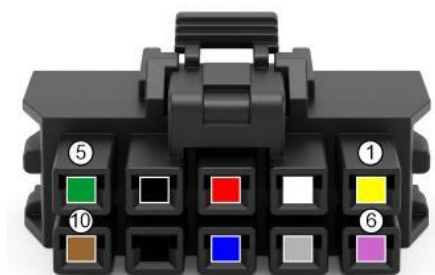
Нумерация выводов разъема БИП-4
